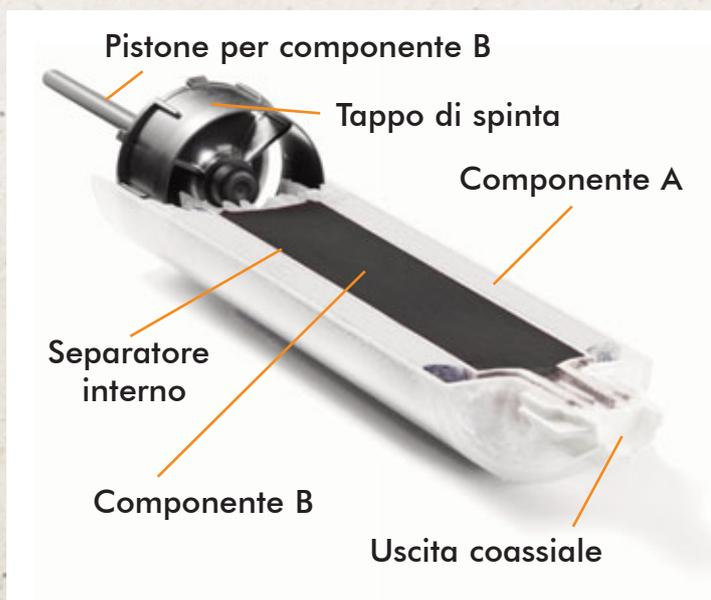
La cartuccia Peeler permette, grazie alla sua geometria interna, di tenere separati l'attivatore (Comp. B) e il mastice (Comp. A). Questi verranno a contatto solo in fase di estrusione, essendo spinti in modo uniforme dal tappo di fondo (utilizzando apposita pistola), e incanalati nel miscelatore il quale provvederà ad amalgamare (grazie alla coclea interna), in modo omogeneo ed uniforme i due componenti.
