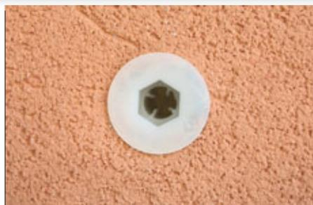
Per il montaggio del tassello IPL 95 inserire la vite M8 x 30 fornita con la scatola nel mandrino con la parte filettata. Infilare la testa esagonale nel tassello IPL 95 ed avvitare.
