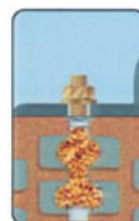
Posizionamento dell'elemento da fissare e serraggio
